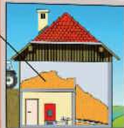
Stockage au dessus de la chaufferie avec tube de chute
