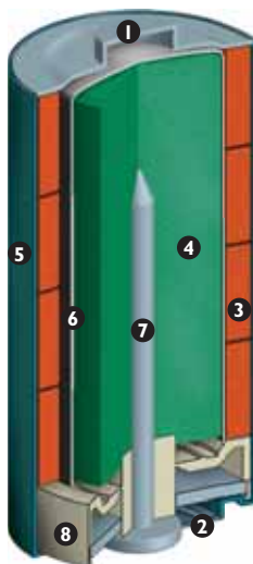
Coupe schématique d'une pile bâton alcaline
